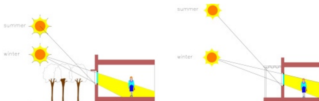
Figure 29 : Représentation du fonctionnement des protections solaires saisonnières [34]
